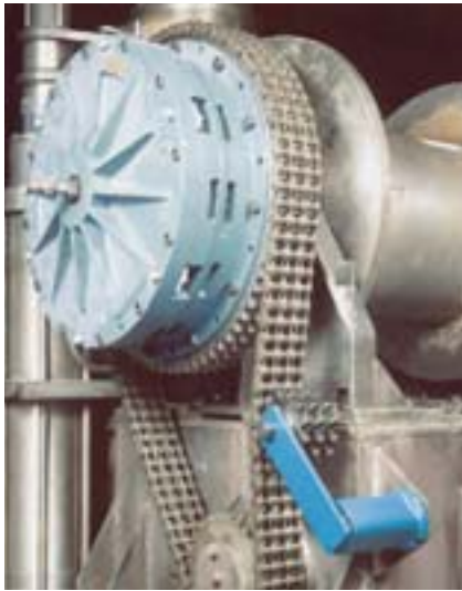
Tensor de cadena en una máquina perforadora en la industria minera
