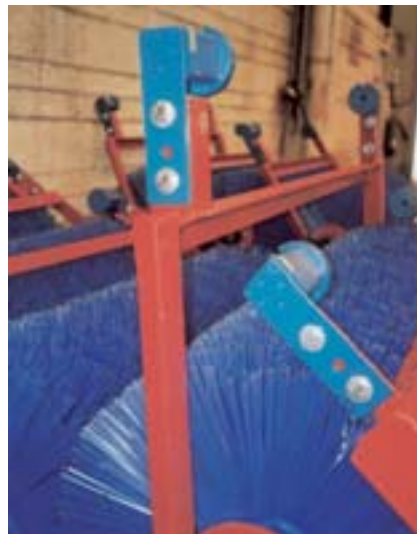
Suspensión de cepillo circular en una cosechadora de patatas
