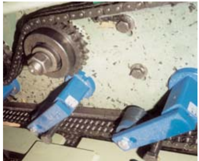
Cadena guía elástica en la entrada de un aserradero
