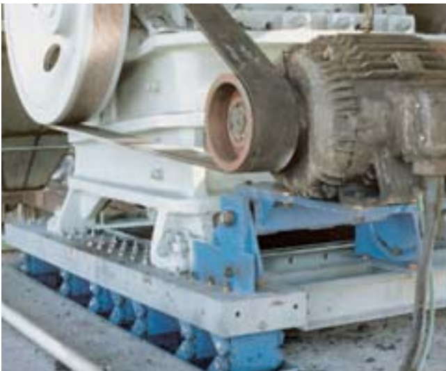
MB 70 en una trituradora de mandíbulas
