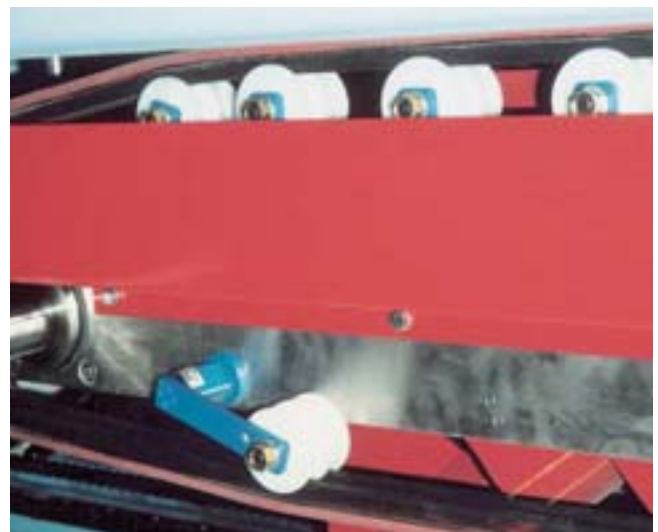
Tensor de correa en la entrada de una pulidora
