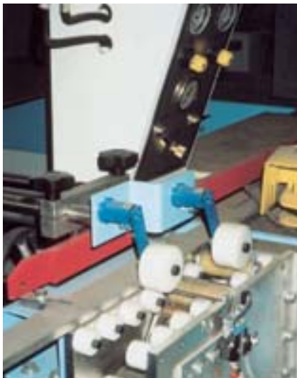
Rodillos tensores en máquina embaladora
