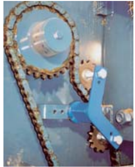
Tensor Boomerang en una máquina agrícola
