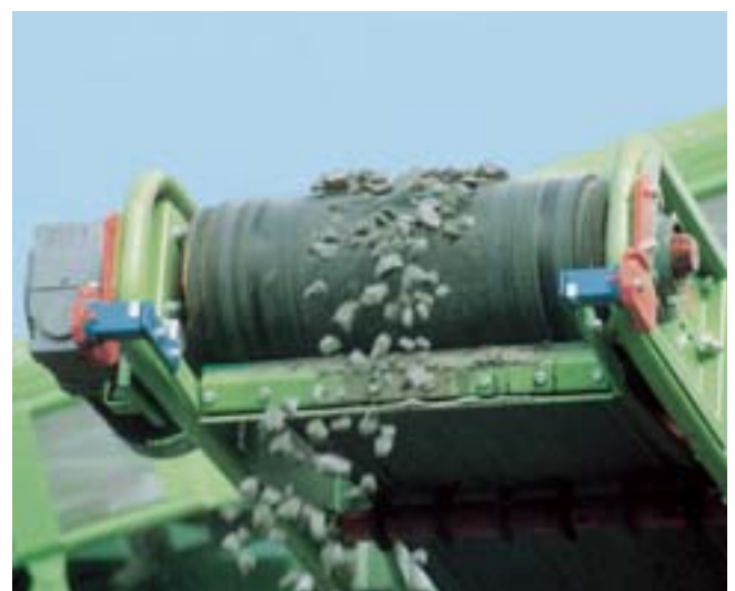
Suspensión elástica en rascador de banda
