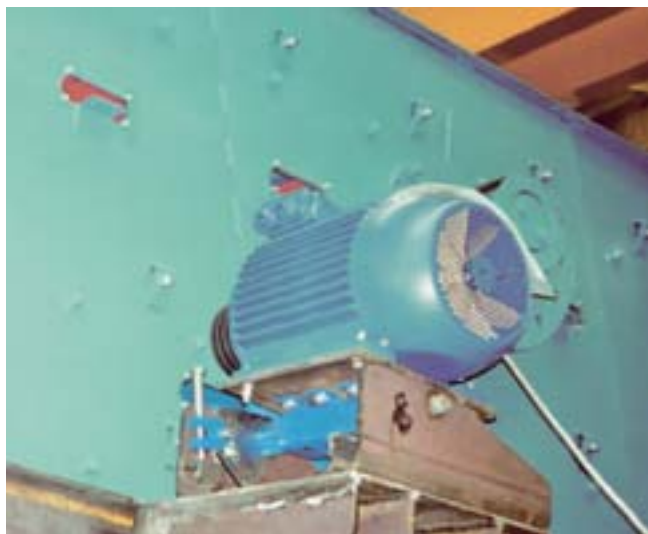
MB 50 en una transmisión por correas en criba circular
